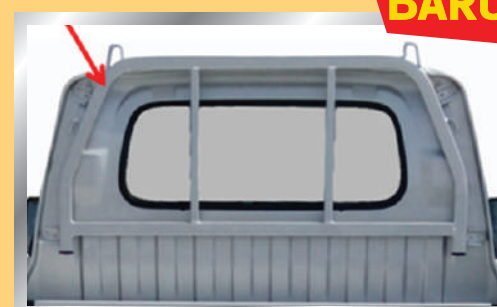
Cabin Guard baru di bagian belakang sebagai pelindung kaca dan bodi bagian belakang.
