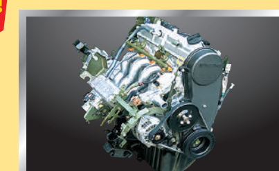
Mesin G15A, Multi Point Injection, lebih irit & bertenaga.
