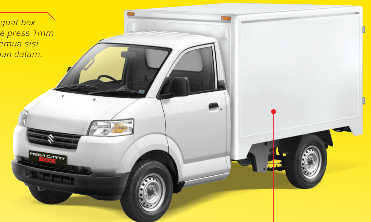
Semua sisi luar box terbuat dari bahan aluminium composite panel, lebih ringan dan tahan atas segala kondisi cuaca
