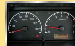
Speedometer dengan indikator bensin, tripmeter & odometer digital.
