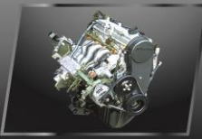
Mesin G15A, Multi Point Injection, lebih irit & bertenaga.
