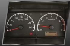
Speedometer dengan indikator bensin, tripmeter & odometer digital.
